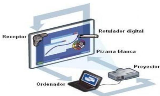
Ilustración 1. Esquema funcionamiento PDI<sup>1</sup>
