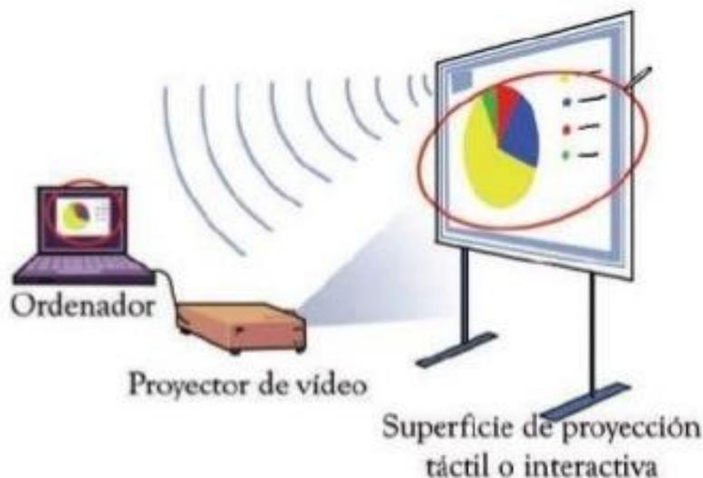
Ilustración 1. Esquema de funcionamiento de la PDI<sup>1</sup>
